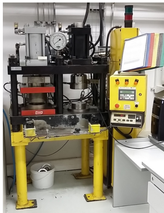
Figuur 14: Persinstallatie A voor het score (links) en testen (rechts) van breekplaten tot twee inches.
