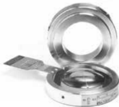
Figuur 6: Breekplaat (type Poly-SD) in houder. De losse disc (2") met naamplaatje is in de base geplaatst met daarnaast een losse holddown. Afdichting is gebaseerd op metaal-op-metaal klemming.
