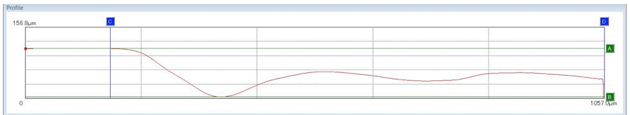
Figuur 50: Doorsnede groef zonder beam off delay. Duidelijke pinhole is waar te nemen en het verloop is grillig.
