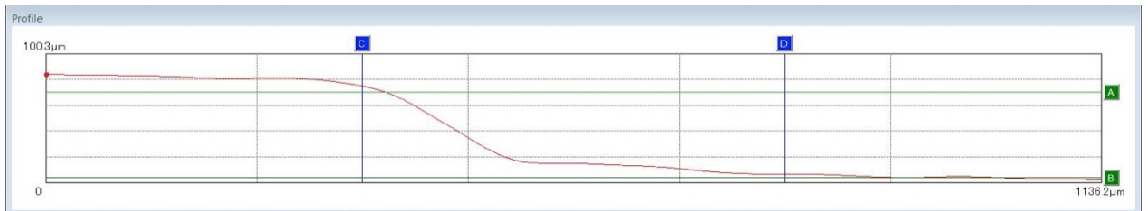
Figuur 51: doorsnede groef weergave met aangepaste beam off delay. De pinhole is vermeden en het verloop is niet meer grillig.
