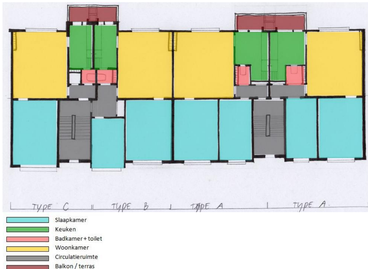
Figuur 110: Halenstraat, v.l.n.r.: type C met één slaapkamer, type B met twee slaapkamers en gespiegeld typeappartement A met twee slaapkamers, eigen schets.
