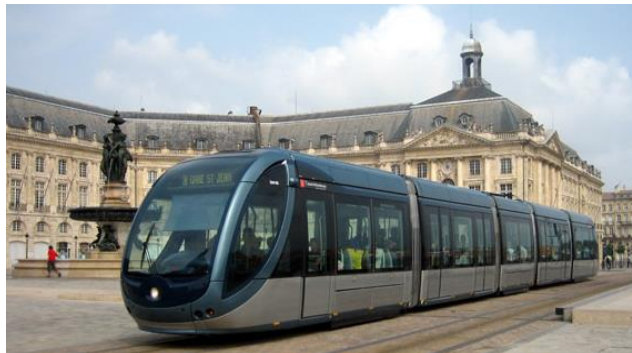
Figuur 19: Citadis-tram met APS in het Franse Bordeaux
