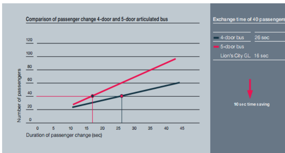
Figuur 25: Vergelijking van de in-/uitstaptijd tussen een bus met vier deuren en één met vijf deuren 32
