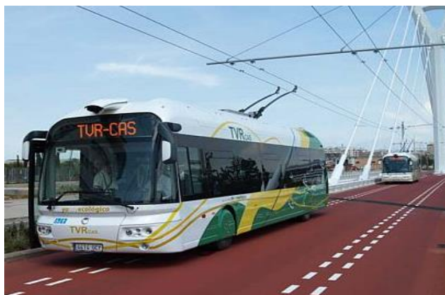
Figuur 18: Crealis-bus met Optiguide-Optiboard in het Spaanse Castellón
