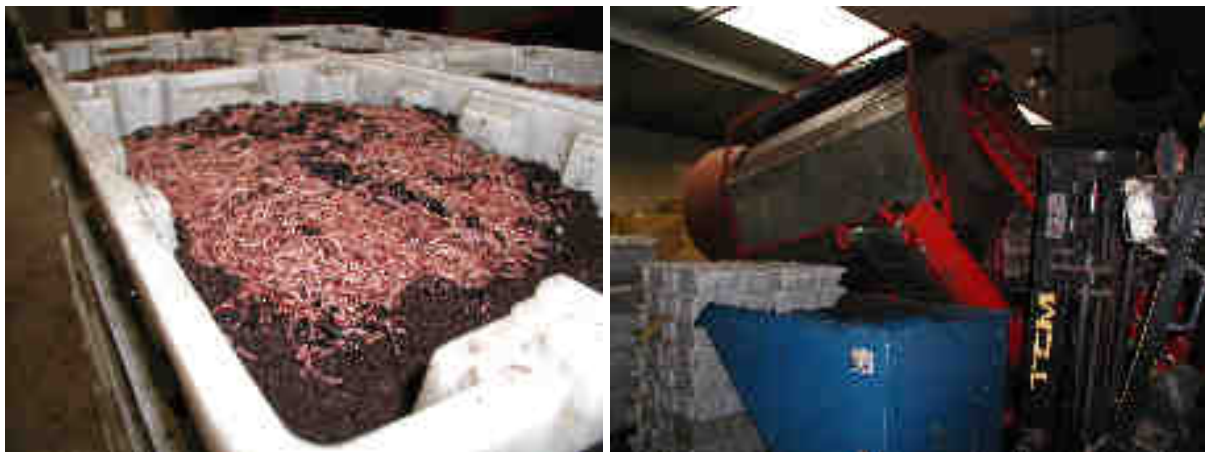
Figuur 26: Oogst en scheiding op de trommelzeef (Mondelinge mededeling: Geeraert, 2005).
