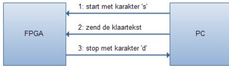
Figuur 4.25: Communicatieprotocol tussen SASEBO en pc
