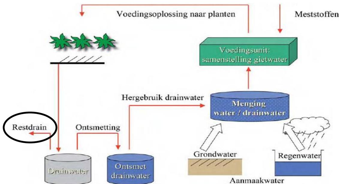
Figuur I-6: Algemeen schema van een recirculatiesysteem met aanduiding van de verschillende waterstromen. Ontsmetting en bemesting zijn de moeilijkste stappen (Blindeman et al., 2006).
