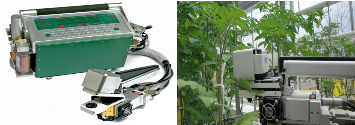
Figuur III-5: Het LI-6400 systeem met de bijhorende fluorescentiekop (links) en een fotosynthese- en/of fluorescentiemeting op een tomaatplant met de LICOR (rechts).
